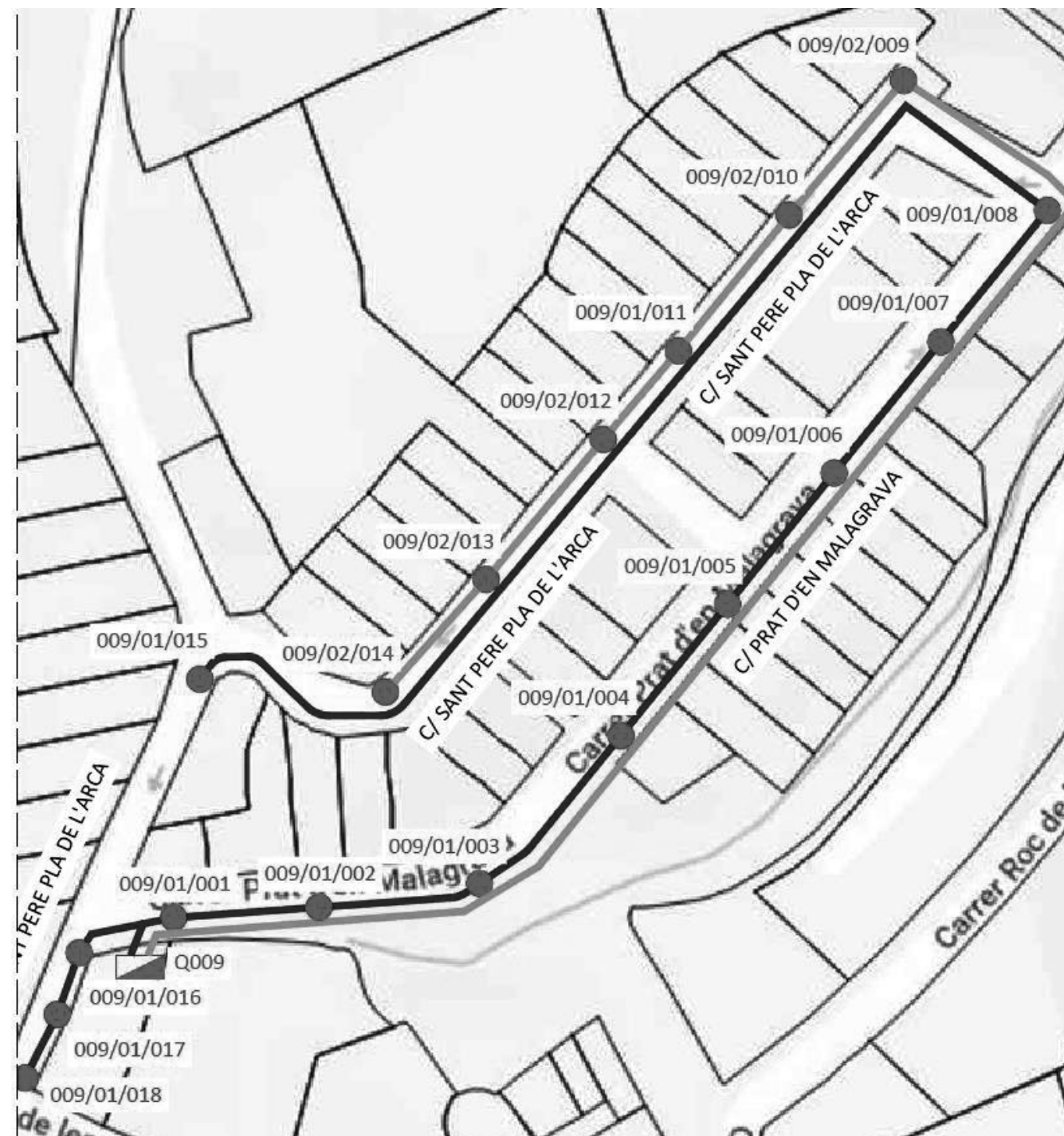
Figura 283. Plànol instal·lació enllumenat públic del quadre núm.009.
