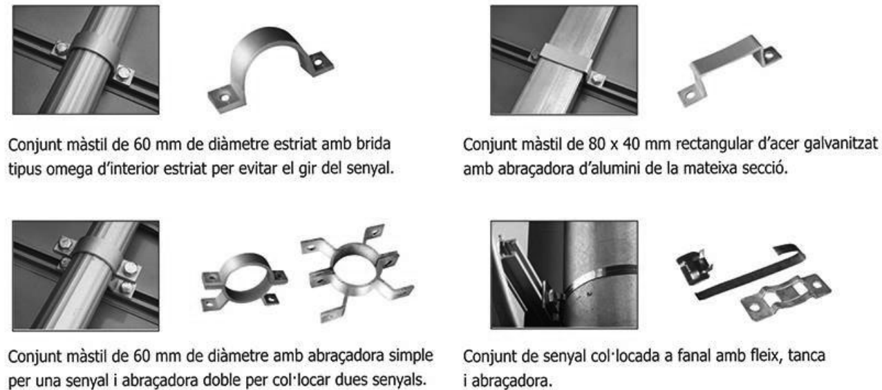
Figura 356. Sistemes de subjecció plaques d'alumini.
